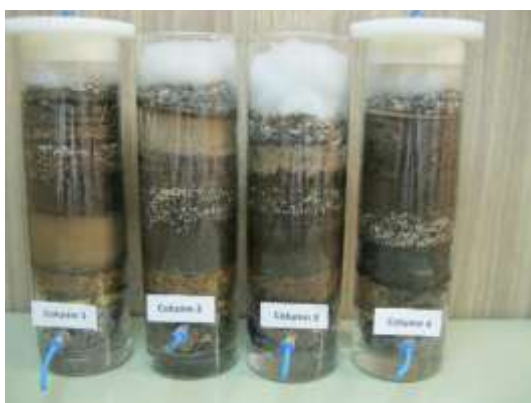
شکل ۱- فیلترهای زیستی طراحی شده با بستریهای مختلف
